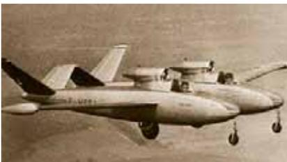
*El Fougas CM-88R Gemeaux I era un avión experimental destinado a ser utilizado como banco de prueba de turborreactores ligeros.*
